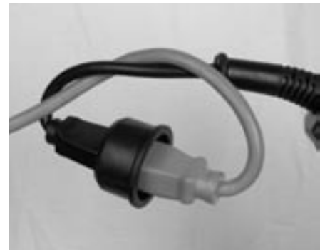
Figura 3-4: Método opcional para retener el cordón de extensión
